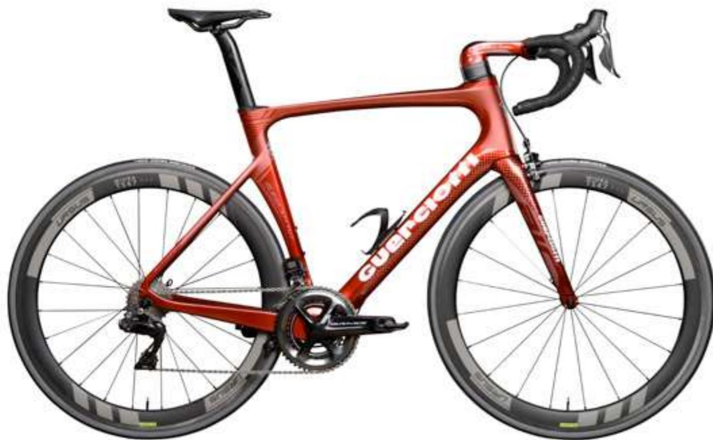
PESO TELAIO / FRAME WEIGHT : Kg 1,090
